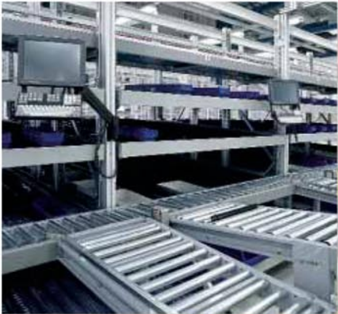
SELECTAFLO-løsningen ovenfor er fullt integrert i et WMS-system. Det håndterer ca. 20 000 enhetslaster om dagen.
