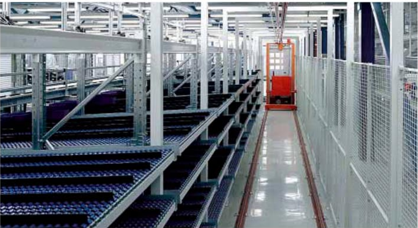
Påfyllingen i Selectaflo gjøres med en automatisk mateinnretning.
