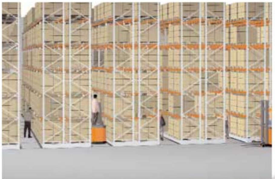
Ved lagerkontroll, kan flere betjeningsganger åpnes samtidig.
