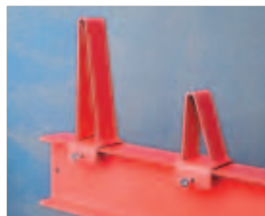
Rørstopp - Justerbar, finnes i to høyder (100, 200mm). Benyttes for lagring av runde rør med stor diame- ter. Erstatter høye endestoppere - gir flere lagringsnivåer.
